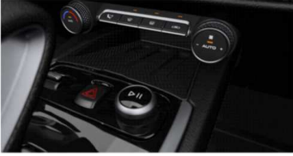
ロータスダイナミックパフォーマンスマネージメントスイッチ(センターコンソールギアセレクターの左前)
